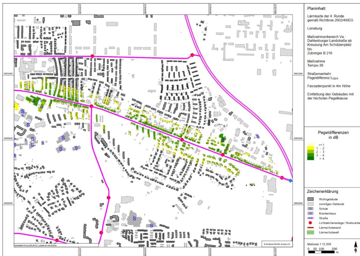
Abbildung 24: Differenzlärmappe zur Maßnahme Temporeduzierung im Maßnahmenbereich  $V_a$
