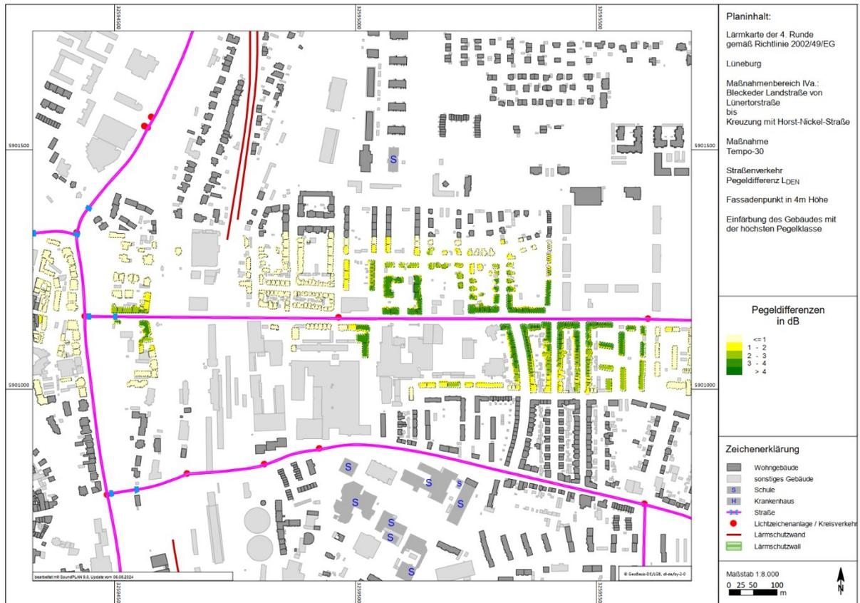
**Abbildung 20:** Differenzlärmkarte zur Maßnahme Temporeduzierung im Maßnahmenbereich IV<sub>a</sub>
