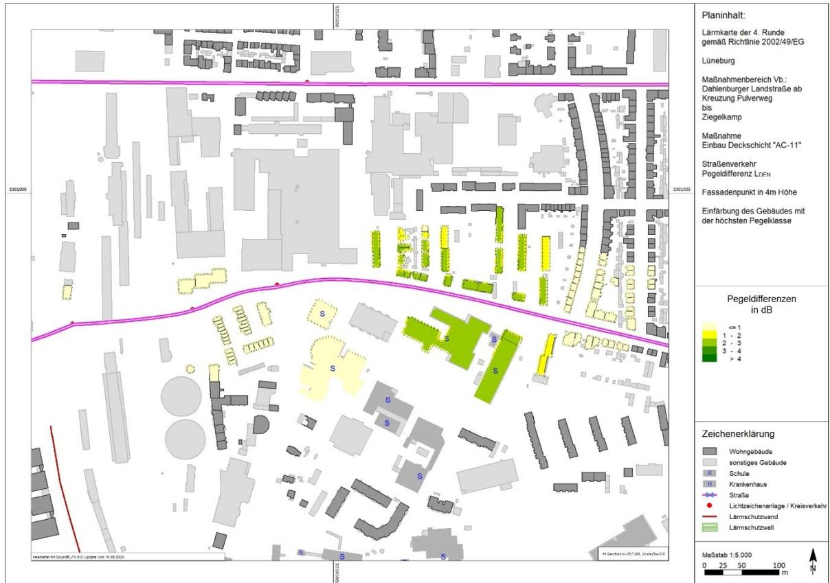
**Abbildung 26:** Differenzlärmappe zur Maßnahme Deckensanierung im Maßnahmenbereich V<sub>b</sub>
