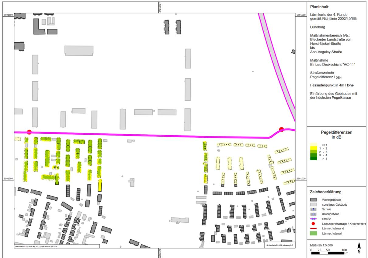
**Abbildung 22:** Differenzlärmkarte zur Maßnahme Deckensanierung im Maßnahmenbereich IV<sub>b</sub>
