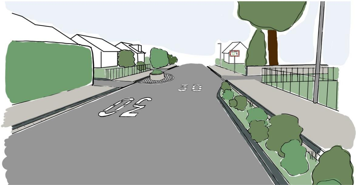
Abbildung 23 - Beispielhafter Entwurf zur Reduzierung der Fahrgeschwindigkeit
