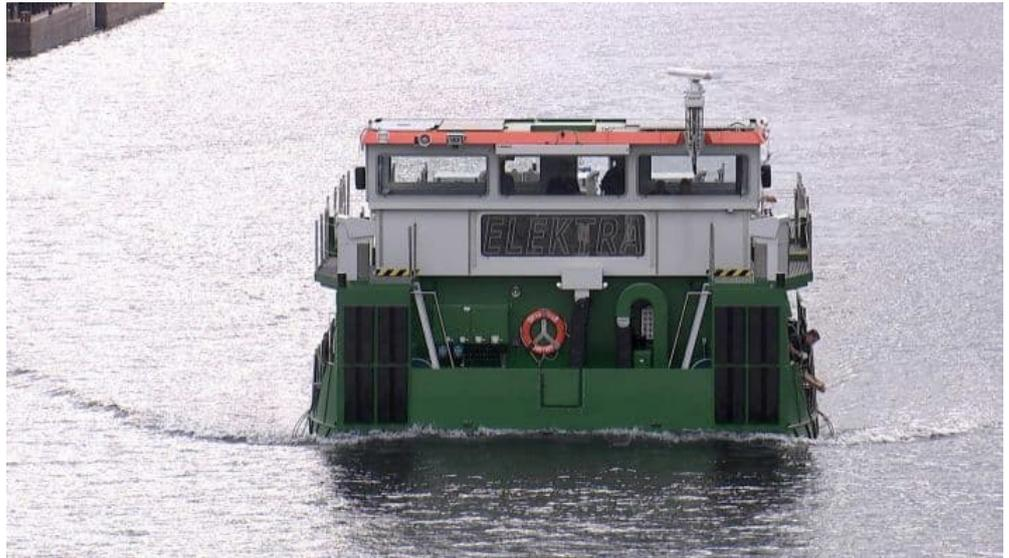
Bild: BEHALA; Schubboot ELEKTRA mit H2-Brennstoffzellen-Antrieb
