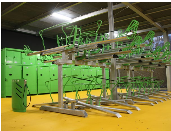
Fahrradparkhaus mit platzeffizientem Doppelstockparksystem, Luftpumpe und abschließbaren Boxen
