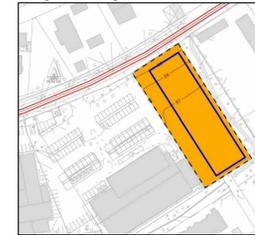
Anlage 4b der Schalltechnischen Untersuchung: Maßgeblicher Außenlärmpegel für Räume, die überwiegend zum Schlafen genutzt werden können
