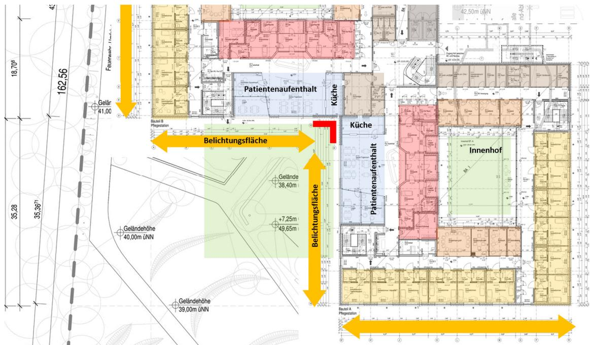
Abbildung 14 \_ Grundrissausschnitt Belichtung im „Innenwinkel“
