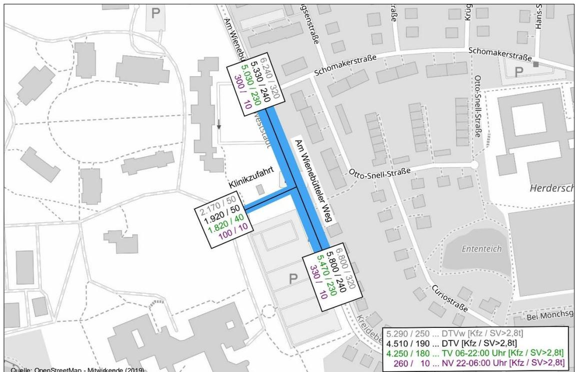
Abbildung 10: Prognoseplanfall 2030 – Querschnittsbelastungen
