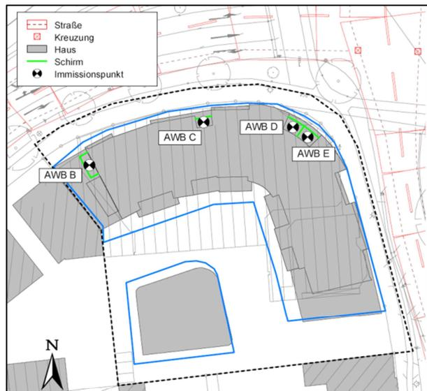
Abbildung 9: Auszug schalltechnische Untersuchung, Abbildung 4, Lage der Außenwohnbereiche, an denen eine Umsetzung von Lärmschutzmaßnahmen erforderlich ist, Quelle: LairmConsult
