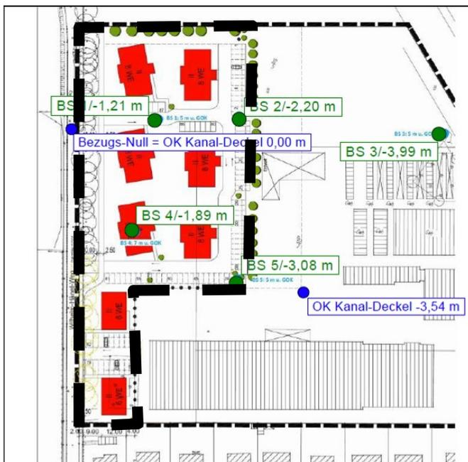
**Abb. 5:** Baugrunduntersuchung (BFB, 11/2016), Auszug aus Anlage 1: Lage der Ansatzpunkte,
