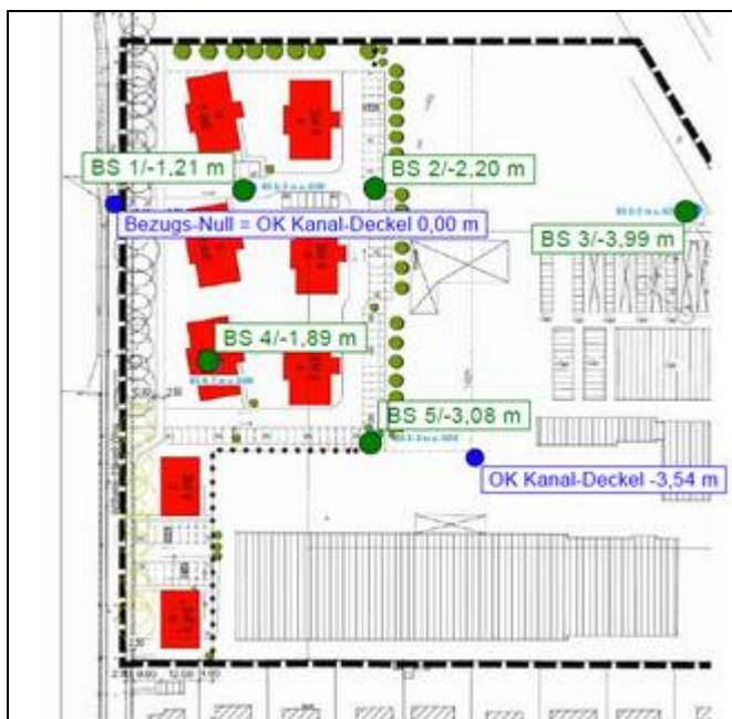
**Abb. 4:** Baugrunduntersuchung (BFB, 11/2016), Auszug aus Anlage 1: Lage der Ansatzpunkte
